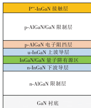
图 1 GaN 外延片结构示意图
