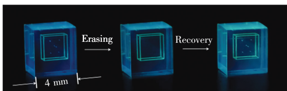
图 10 演示可逆的 CsPbBr 3 QDs 3D 结构的较大尺寸立方体样品的照片,里面的点可以完全抹去和恢复 [83] 。
