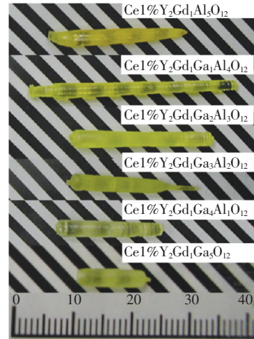
图 16 微拉法生长的 (\text{Y},\text{Gd})_3(\text{Ga},\text{Al})_5\text{O}_{12} 单晶 [59]
