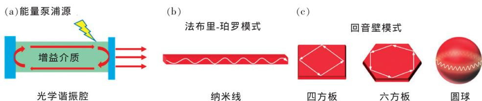
图1 激光器的结构示意图(a)、法布里-珀罗(b)及回音壁模式(c)谐振腔<sup>[9]</sup>。
