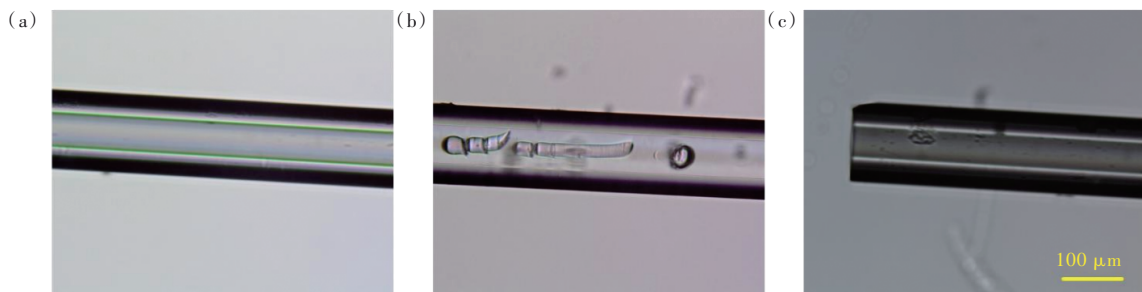
图6 热固化PDMS纤芯光纤光学显微镜照片。(a)热固化前,光纤纤芯连续无气泡;(b)空气中 85\ ^\circ\text{C} 固化30 min,光纤纤芯不连续;(c)真空干燥箱中 85\ ^\circ\text{C} 固化30 min。
