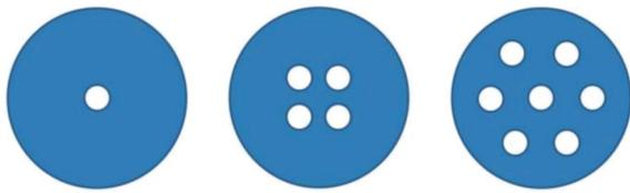
图 11 单芯、4芯、7芯光纤结构图。
