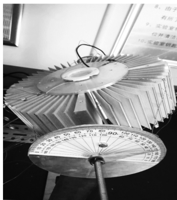
图3 出光倾角测试实验台
