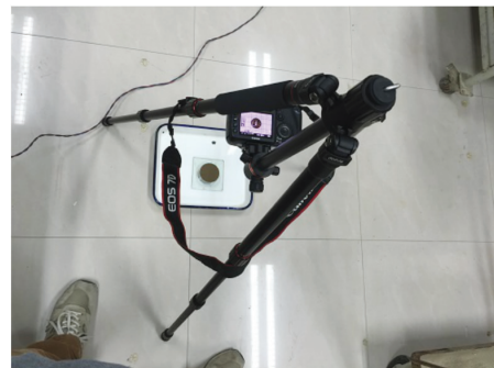
图2 色彩对比实验土样照片拍摄
