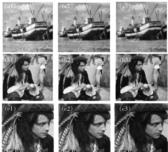
图 9 3 种不同算法下的成像结果。a1 ~ a3 为 boat 图像在 TVAL3、EWT-ACS 及本文算法下的结果;b1 ~ b3 为 man 图像在 TVAL3、EWT-ACS 及本文算法下的结果;c1 ~ c3 为 b1 ~ b3 图像放大后的面部图像。
