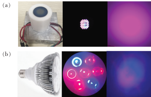
图 2 植物灯对比图。(a) 实验所用灯具; (b) 传统 LED 植物照明灯。
