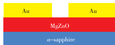
图1 Au-MgZnO-Au 紫外探测器结构示意图
