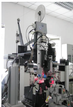
图 1 双目显微视觉检测系统
