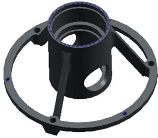
图 4 三叶板组件的设计图
