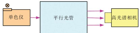
图 1 高光谱遥感器实验室光谱定标示意图
