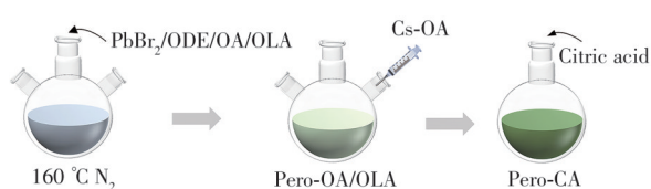
图1 热注射法合成CsPbBr 3 纳米晶及配体交换过程示意图
